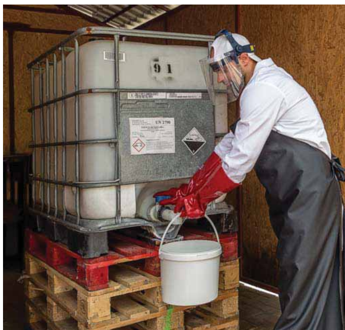
Fot. 18. Przy przelewaniu ciekłych substancji chemicznych i biologicznych należy stosować środki ochrony oczu oznaczone symbolem 3 .
