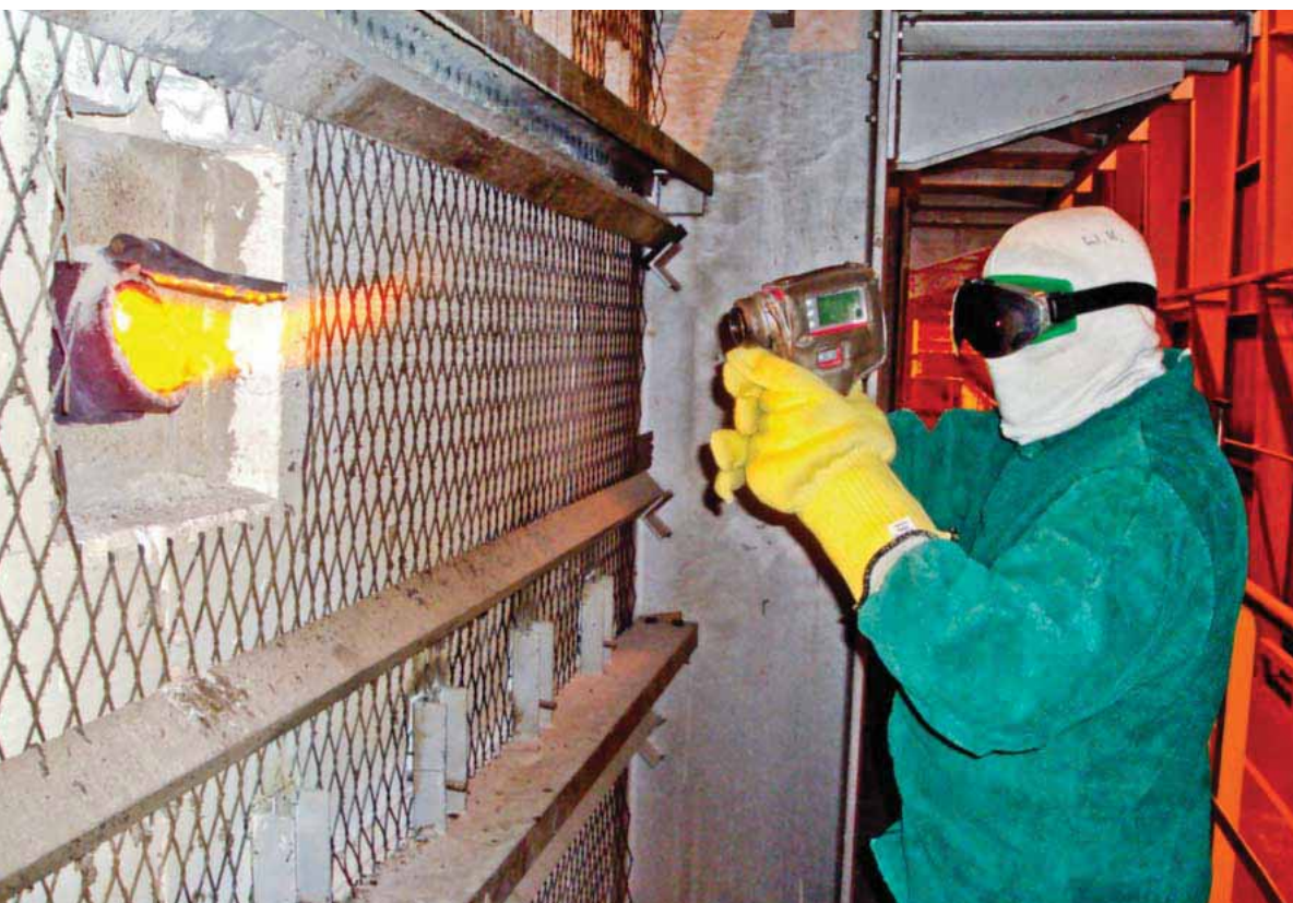
Fot. 22. Środki ochrony oczu stosowane w hutnictwie powinny mieć filtry chroniące przed promieniowaniem podczerwonym.
