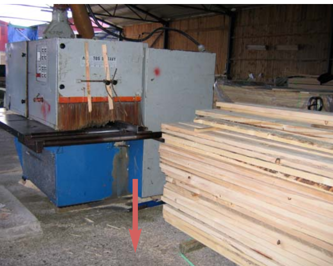
Fot. 1. Stanowisko pracy przy obsłudze wielopiły. Miejsce, w którym przebywał poszkodowany w chwili wypadku (brak urządzenia podającego, operator ręcznie podawał obrabiany materiał do wielopiły, stojąc w strefie jego odrzutu lub wyrzutu).
