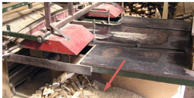
Fot. 2. Stanowisko pracy przy obsłudze maszyny - miejsce, w którym przebywał poszkodowany w chwili wypadku (brak osłony dolnej części tarczy piły znajdującej się pod stołem roboczym).
