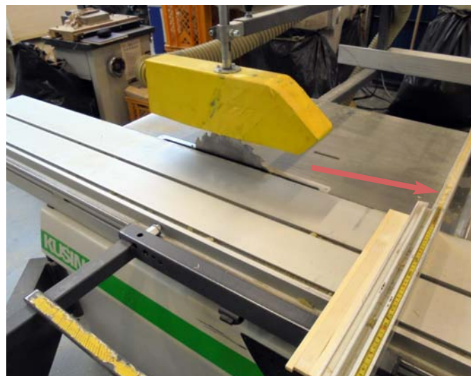
Fot. 1. i 2. Stanowisko pracy przy obsłudze pilarki formatowej – miejsce, w którym przebywał uszkodzony w chwili wypadku (na zdjęciach brak prowadnicy materiału do cięcia wzdłużnego).
