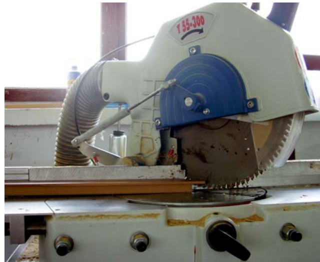
Fot. 2. Głowica pilarki wraz z tarczą tnącą (widoczne ślady krwi na tarczy piły).
