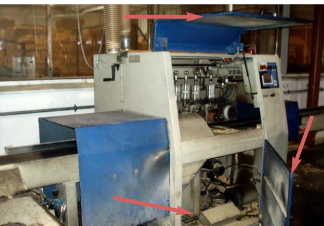
Fot. 1. Pilarka optymalizująca - widok z przodu maszyny. Strzałki wskazują kasetę z piłą oraz osłony ruchome (górną i dolną - drzwiczki) wyposażone w urządzenie blokujące.
