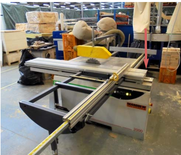
Fot. 1. i 2. Stanowisko pracy przy obsłudze pilarki formatowej – miejsce, w którym przebywał uszkodzony w chwili wypadku (na zdjęciach brak prowadnicy materiału do cięcia wzdłużnego).
