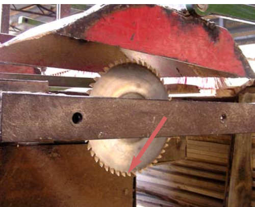
Fot. 3 i 4. Widoczna niezabezpieczona dolna część tarczy piły znajdująca się pod stołem (pod tarczą piły stworzyła się przysma żryznów, którą pracownik próbował usunąć nogą).
