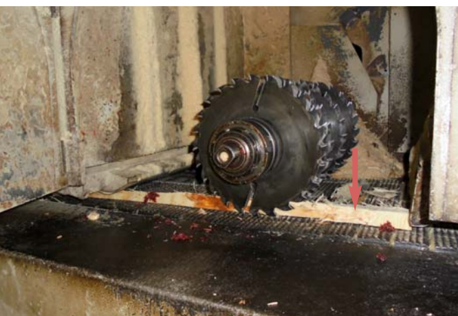
Fot. 5. i 6. Widoczny obrzyn zablokowany pod wałem piłowym.
