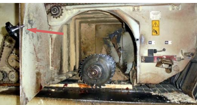
Fot. 7. Drzwi skrzyni dociskowej z widocznym czarnym pokrętle, które poszkodowany musiał odkręcić, aby wyjąć amputowaną rękę.
