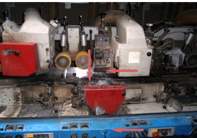
Fot. 2. Strugarka czterostronna, listwa dociskowa, o którą oparł się uszkodzony oraz wrzeciono, które amputowało mu palec.
