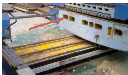
Fot. 3. Widoczny jeden z otworów zlokalizowanych w ramie formatyzerko czopiarki, do którego pracownik włożył dłoń, czyszcząc maszynę.
