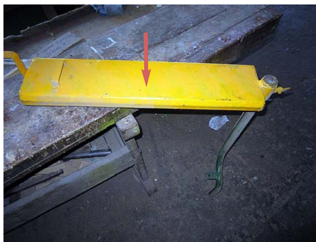
Fot. 3. Strugarko-wyrówniarka - zdemonstrowana osłona wału roboczego.
