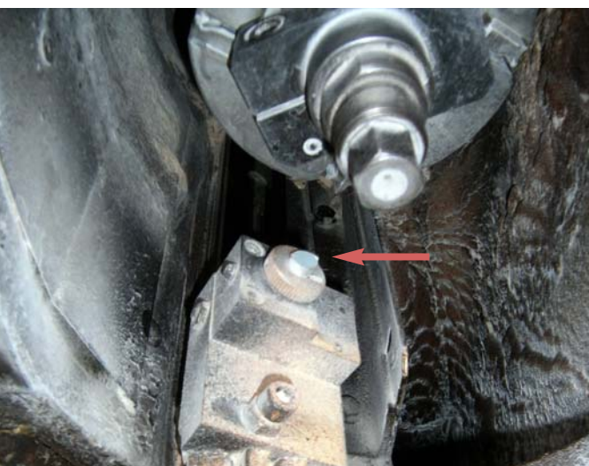
Fot. 4. Strugarka czterostronna - mechanizm ostrzenia noży wraz z kamieniem jointerowym („osełką”).
