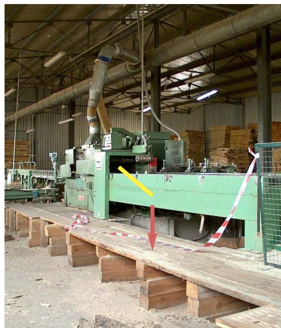
Fot. 2. Miejsce, w którym przebywał uszkodzony w chwili wypadku, i prawdopodobny tor lotu „obrzynka”.
