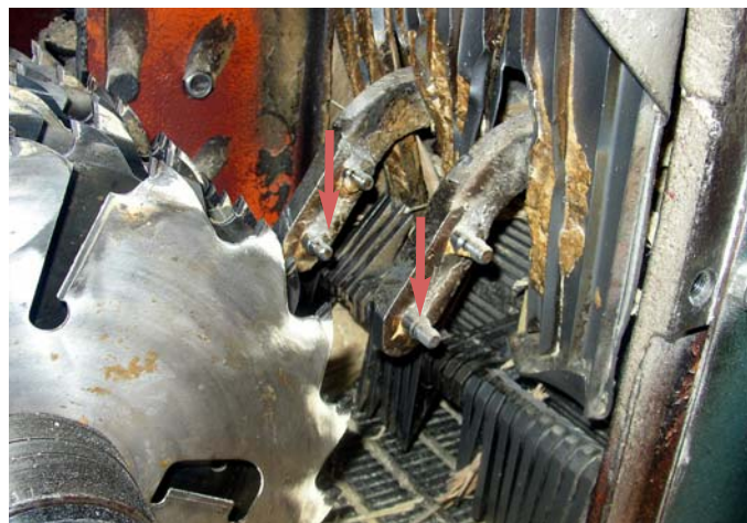
Fot. 4. Brak rolki odsprężynowanej przy wielopile.
