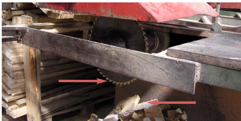
Fot. 3 i 4. Widoczna niezabezpieczona dolna część tarczy piły znajdująca się pod stołem (pod tarczą piły stworzyła się przysma żryznów, którą pracownik próbował usunąć nogą).
