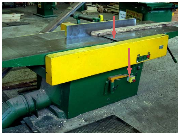
Fot. 2. Strugarko-wyrówniarka - brak osłony nieroboczej części wału roboczego. Urządzenie pomocnicze, z którego nie skorzystał poszkodowany.
