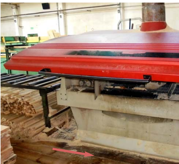
Fot. 1 i 2. Stanowisko pracy przy obsłudze wielopily – miejsce, w którym przebywał (kucnął) poszkodowany w chwili wypadku (widoczna uniesiona osłona dźwiękochłonna, stanowiąca jednocześnie zabezpieczenie przed dostępem do wału piłowego).
