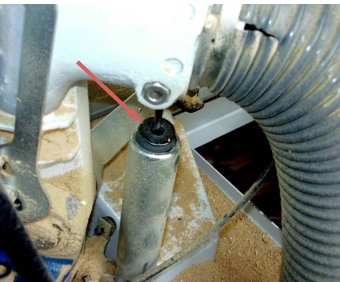
Fot. 3. Mechanizm unoszenia głowicy tnącej pilarki.
