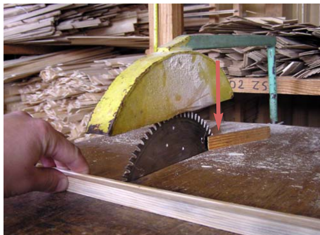
Fot. 2. Niewłaściwie ustawiona osłona w stosunku do grubości obrabianego materiału.
