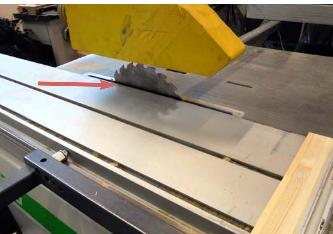
Fot. 3. i 4. Widok na tarczę piły – brak klina rozszczepiającego.
