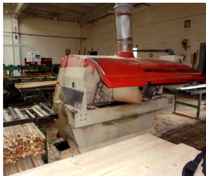
Fot. 1 i 2. Stanowisko pracy przy obsłudze wielopily – miejsce, w którym przebywał (kucnął) poszkodowany w chwili wypadku (widoczna uniesiona osłona dźwiękochłonna, stanowiąca jednocześnie zabezpieczenie przed dostępem do wału piłowego).
