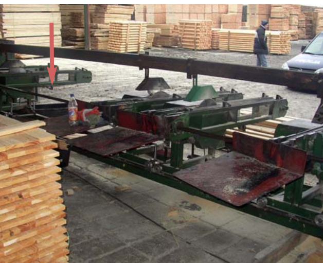
Fot. 1. Pilarka formatująca (pięciopiła) – widok od strony odbiorczej, miejsce wypadku.
