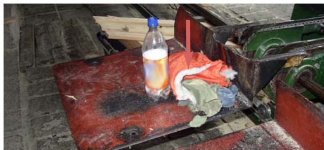
Fot. 3. Pilarka formatująca (pięciopiła) – fragment kurtki poszkodowanego nawiniętej na wałek napędowy przenośników łańcuchowych.
