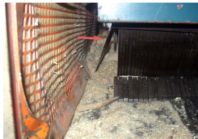
Fot. 5 i 6. Uszkodzona (wygięta) ruchoma osłona boczna kierująca wyrzucany materiał na drugi (liczony od wału roboczego) rząd zapadek przeciwozdrzutowych.
