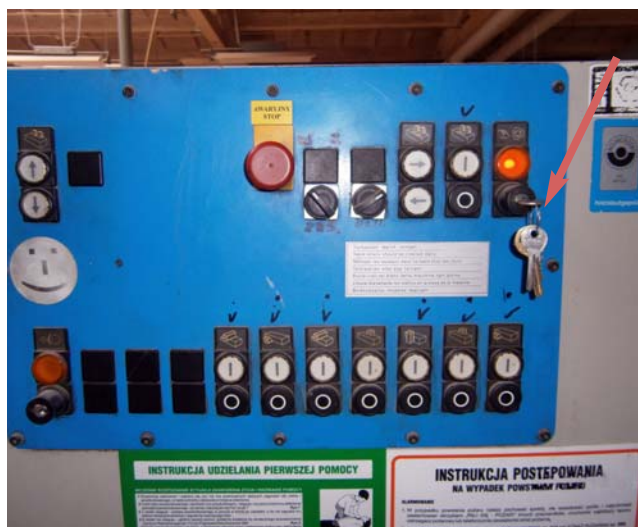
Fot. 5. Strugarka czterostronna - pulpit sterowniczy.
