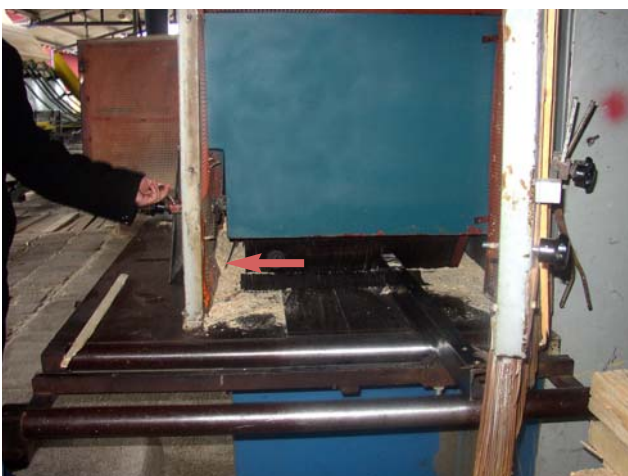
Fot. 5 i 6. Uszkodzona (wygięta) ruchoma osłona boczna kierująca wyrzucany materiał na drugi (liczony od wału roboczego) rząd zapadek przeciwozdrzutowych.
