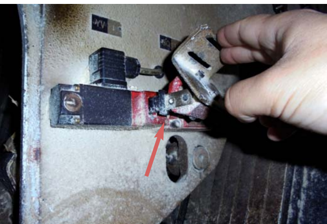
Fot. 3. Uszkodzony zamek elektromagnetyczny urządzenia ochronnego (klucz tkwiący w zamku pomimo podniesionej osłony).
