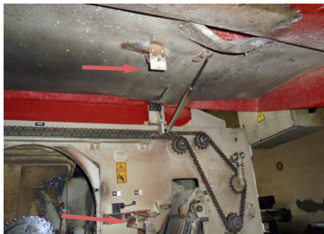
Fot. 4. Widoczna część uchwyty od klucza do zamka elektromagnetycznego przy podniesionej osłonie i druga część uchwyty wraz z kluczem (poniżej na zdjęciu).
