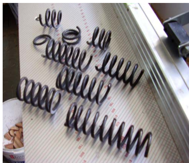
Fot. 4. Uszkodzone sprężyny wchodzące w skład zespołu unoszenia głowicy tnącej.
