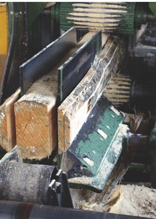
Fot. 11. Przebieg tarcicy przez urządzenie rozdzielające traka.
