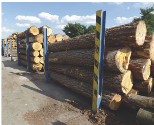
Fot. 2. Zabezpieczenie mygieł, drewno składowane na legarach.
