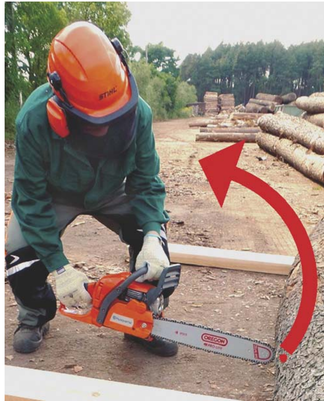
Fot. 10. Niewłaściwe przyłożenie piły do materiału grożące tzw. odbiciem.
