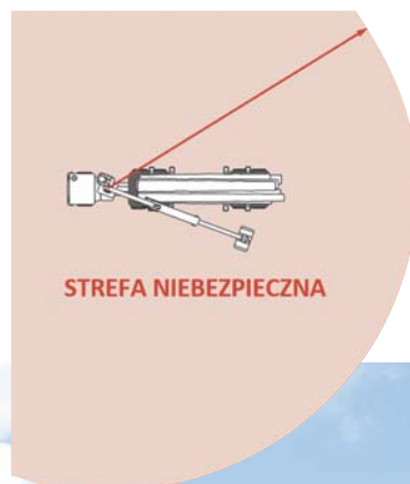
Rys. 1. Wyznaczenie strefy niebezpiecznej wokół pojazdu podczas rozładunku.
