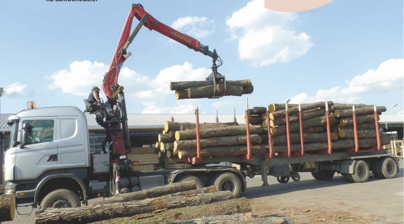
Fot. 1. Rozładunek kłód z użyciem żurawia zamontowanego na samochodzie.
