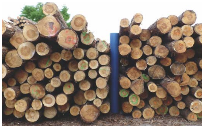
Fot. 3. Mygły zabezpieczone słupem oporowym.
